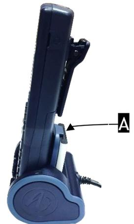
Pour retirer la batterie de rechange, la pousser vers le bas et vers l'arrière pour la déposer.
