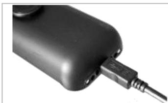
Brancher directement le câble USB sur votre téléphone. L'autre extrémité du câble USB peut être raccordée à l'adaptateur AC/DC ou à une prise USB d'un ordinateur par exemple.
