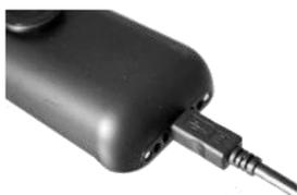
Brancher directement le câble USB sur votre téléphone. L'autre extrémité du câble USB peut être raccordée à l'adaptateur AC/DC ou à une prise USB d'un ordinateur par exemple.
